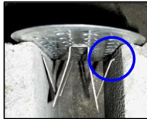
ハネ先端部(ツメ)が穴の内部に掛かり、ストッパーの役割を果たします。押し込みが不十分だと製品が少し浮いた状態になり、外れ易くなるので注意して下さい。
