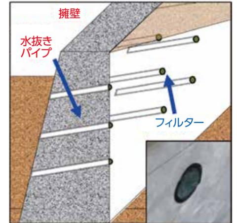
◆擁壁用透水マット 損傷防止保護材
