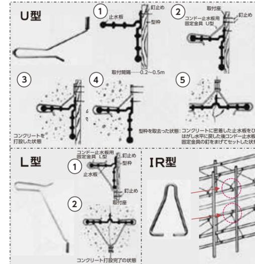
◎ 塩ビ製打ち継ぎ止水板を取り付ける際の必需品です。
