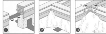
1 墨出し、水系に合わせて水平をとりつつ接続面の離型紙をはがし、直線ジョイントを差し込んで圧着接続します。ブラケットで支えて安定させ接続します。2 モルタルを、富士山状にして固定します。その後目地材両サイドを、全面モルタルにて補強します。3 モルタル固定後、押えコンクリート打設前に必ずキャップ両側の離型紙を全面にはがします。はがさない場合、目地が飛び出すおそれがあります。
